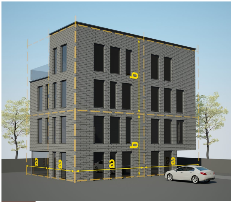
Rys. 1. Przykładowe rozmieszczenie dylatacji budynku.
