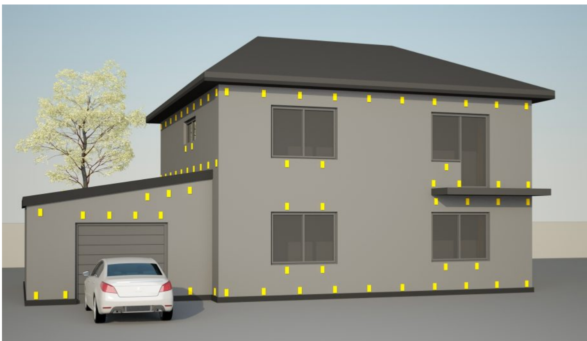
Rys.23. Rozmieszczenie puszek w elewacji - przykład.
