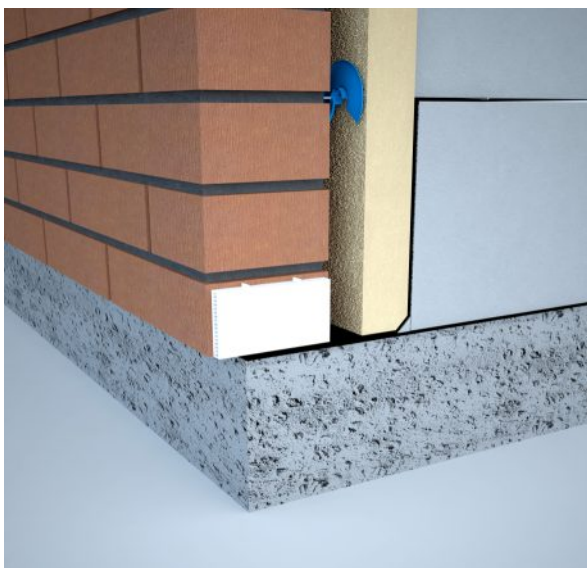
Rys. 22. Zastosowanie puszki wentylacyjno - odwadniającej.
