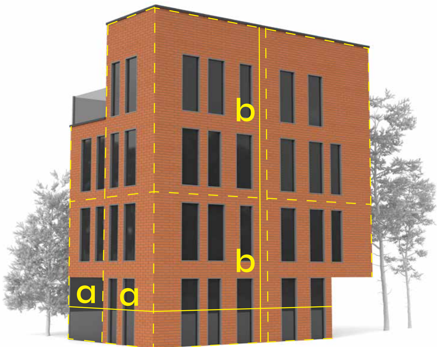
Рис. 6 - Приклад розташування вертикальних та горизонтальних деформаційних швів
