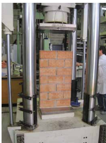
Rys. 6 Ścianki murowe w maszynie testowej
